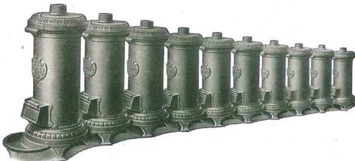
Ces calorifères n'ont ni grille, ni tiroir à cendres; la combustion s'opère sur une sole en terre réfractaire. Le fût, en tôle, est garni intérieurement sur toute sa hauteur de briques réfractaires. La porte d'admission d'air est coulissante. La buse est placée dessus ou derrière.
