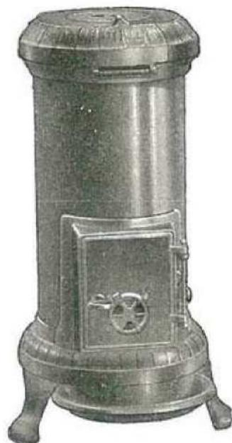
N<sup>os</sup> 1 A, 2 A, et 3 A. — Ces calorifères ont une grille pivotante manœuvrable de l'extérieur. Fût en forte tôle d'acier garni intérieurement sur toute sa hauteur d'une épaisse garniture de briques réfractaires.
