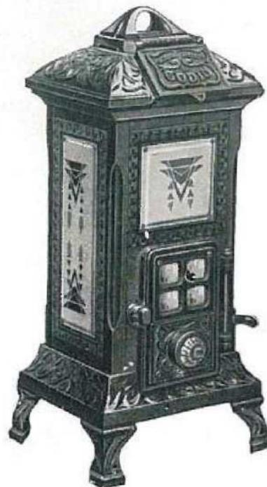
Ces calorifères ont le foyer garni de terre réfractaire, grille pivotante. Le réglage s'opère : 1° par la valve de la porte de cendrier ; 2° par la poignée placée sur le côté droit et commandant la valve de la buse. **Buse mobile placée dessus ou derrière**, sauf quand les appareils sont demandés à buse coude en bas.
