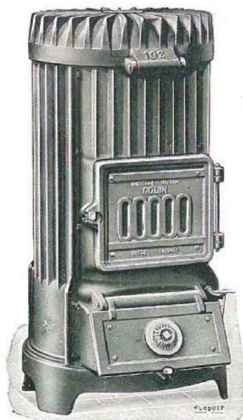
Ce sont des appareils puissants, robustes, économiques, faciles à conduire et à entretenir. Le foyer est en fonte, garni d'ailettes extérieurement, et intérieurement d'une épaisse garniture de briques réfractaires. Les portes de foyer et de cendrier sont à joint d'amiante. Le réglage se fait par valve à vis. Buse mobile, placée dessus ou derrière.
