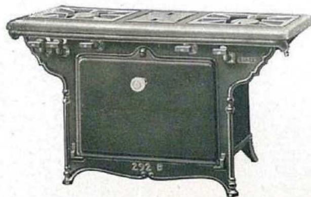
Dessus plan muni de chaque côté d'un brûleur « Clasen » N°s 2 et 3. Le four est muni : à la partie supérieure de 2 brûleurs droits à griller à flammes bleues horizontales avec déflecteurs alimentés chacun par un robinet ; à la partie inférieure d'un brûleur « Clasen » N° 2 disposé sous un tampon à charnières assurant le soufflage des flammes horizontales.
