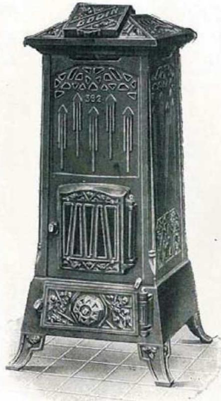
Ils possèdent un foyer cylindrique en tôle garni intérieurement de terre réfractaire, grille pivotante, porte de cendrier avec valve à vis pour l'admission de l'air. Buse mobile placée à volonté dessus ou derrière en haut. Buse coude en bas pour le N<sup>o</sup> 390 seulement.
