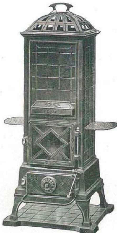
Ce calorifère est revêtu intérieurement d'une garniture réfractaire. **Toujours livré avec plaque de parquet, tablettes sur les côtés, plaque de protection, à buse derrière et, sauf indications contraires, en fonte ordinaire, accessoires (valve, poignée du dessus) nickelés, porte de chargement rectangulaire, à joint d'amiante, pour l'usage du bois.**
